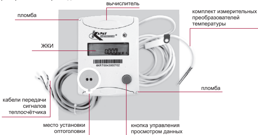
Рисунок 4 — Измерительная часть теплосчётчика
